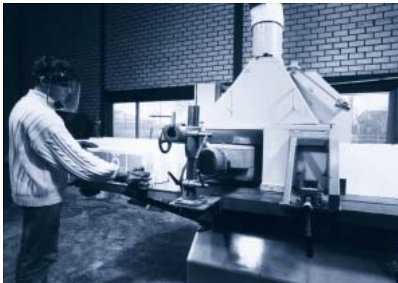
Samengestelde EPS-bouwproducten: gloeidraden scheiden EPS van 'vreemde' materialen.
