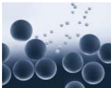
EPS van korrel tot parel: expansieproces met behulp van stoom, waardoor EPS voor maar liefst 98% uit lucht bestaat.
