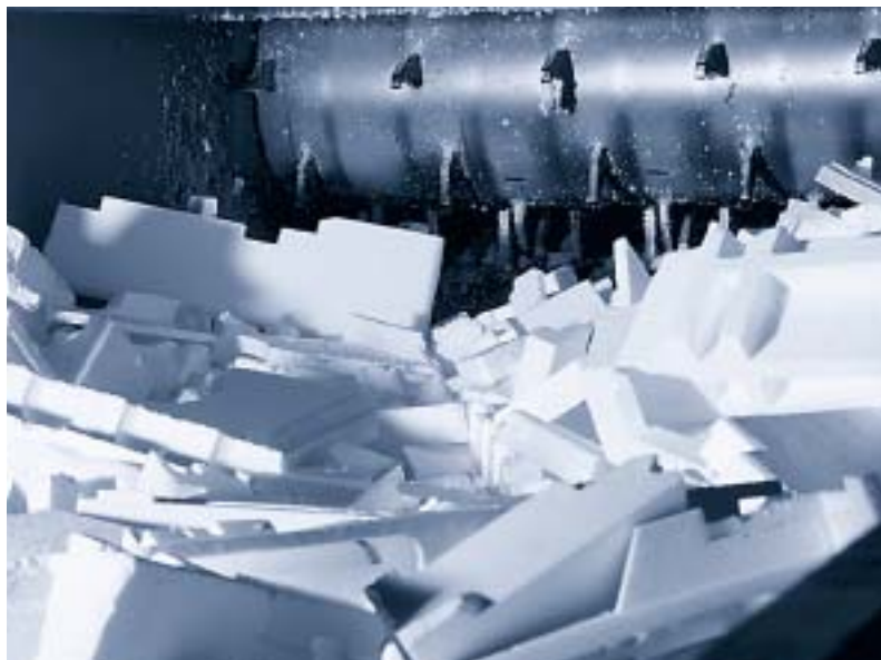
Productieresten worden door de producenten zelf vermalen en direct hergebruikt.
