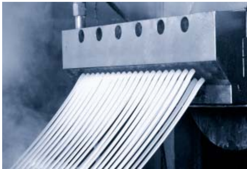
Gebruikt EPS geëxtrudeerd tot PS-granulaat voor spuitgietprodukten.
